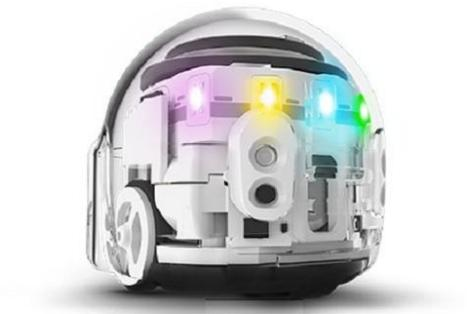
Ozobot est un très petit robot qui roule et qui possède sous sa base des capteurs lui permettant de prendre des informations de couleurs. Il obéit à des instructions codées par des successions de couleurs. On peut ainsi programmer ce robot simplement en dessinant des lignes de couleur sur du papier.
